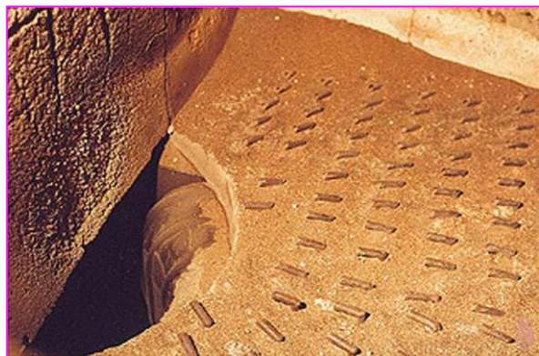
Рис. 5 Решётка кипящего слоя с направляющими соплами в районе бокового выпуска полукокса
