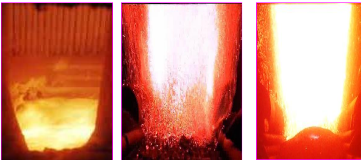
Рис. 4 Кипящий слой при старте: слева – разогрев инертного наполнителя, в центре - начало подачи топлива, справа – дожигание летучих при получении полукокса
